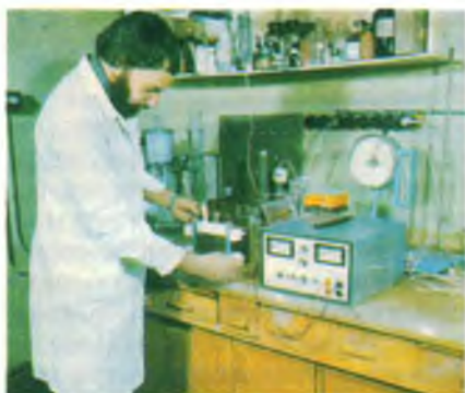
Аппарат для зонального электрофореза вирусов. Здесь создается электрическое поле, под действием которого частицы в препарате (обломки белков, вирионы и т. д.) разделяются послойно.
